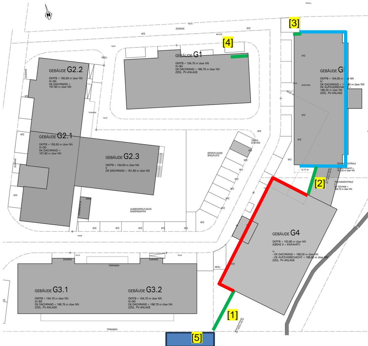
Abbildung 4: erforderliche Schallschutzmaßnahmen
