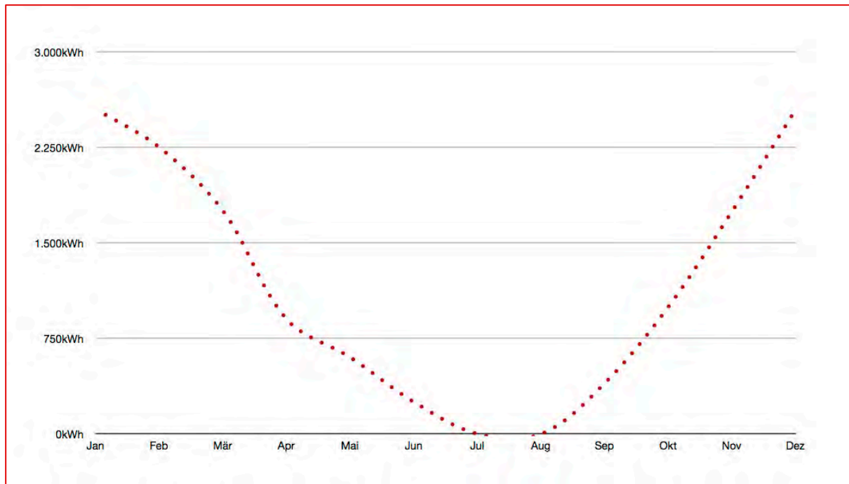
Abbildung 68 – Typischer jährlicher Verlauf des Wärmebedarfs eines Einfamilienhauses. Eigene Darstellung CHROSIS und neuland+, 2014.
